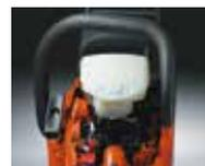
Extracción rápida de filtro de aire
